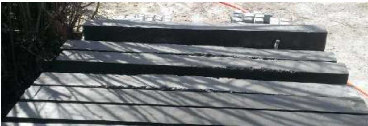
شکل ۱-۲: تیرهای بتن مسلح ساخته شده در آزمایشگاه
