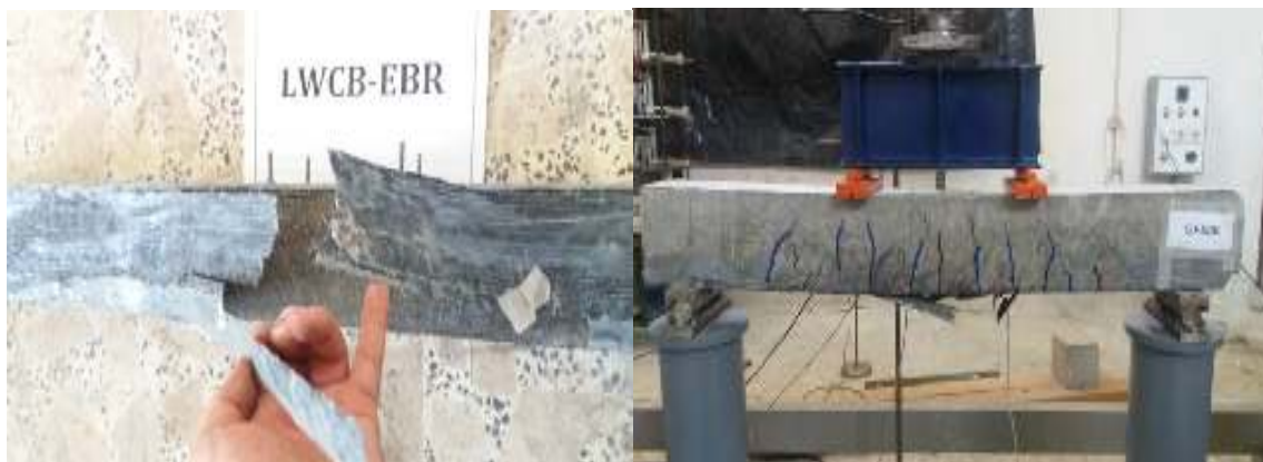
ب) مود شکست تیرهای بتن سبک فاقد الیاف و بتن معمولی در مطالعه مدندوست و رحیمی [۲۷] شکل ۲-۳: مود شکست تیرهای بتن مسلح تقویت شده به روش EBR
