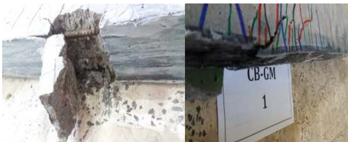
ب) مود شکست تیرهای بتن سبک فاقد الیاف و بتن معمولی در مطالعه مدندوست و رحیمی [۲۷] شکل ۳-۳: مود شکست تیرهای بتن مسلح تقویت شده به روش GM
