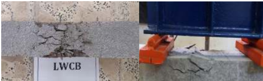
ب) مود شکست تیرهای بتن سبک فاقد الیاف و بتن معمولی در مطالعه مدندوست و رحیمی [۲۷] شکل ۱-۳: مود شکست تیرهای بتن مسلح شاهد
