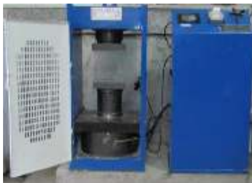
شکل ۲- جک شکننده ی نمونه های بتن ترکیبی
